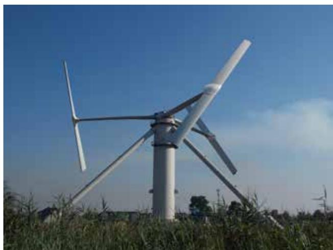
**Fig. 1 :** Concept d'éolienne offshore de Nénuphar Wind.
