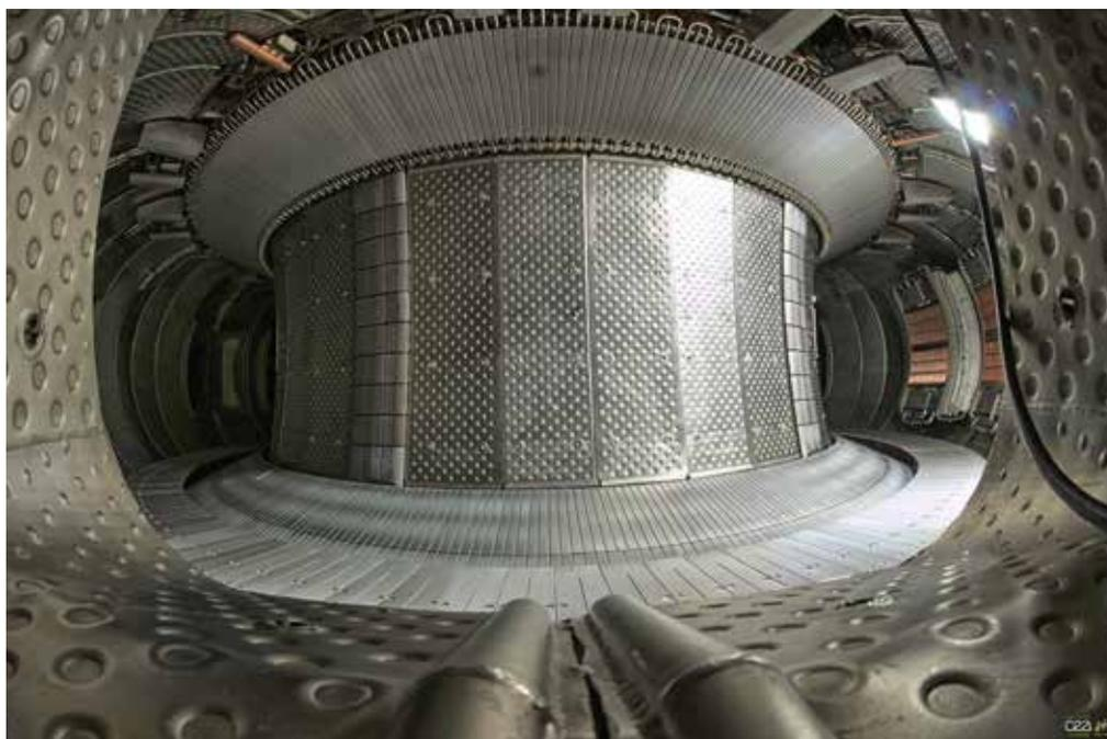
**Figure 1 :** Vue intérieure du tokamak WEST avant les premiers plasmas. En fonctionnement, ce volume torique sera occupé par un plasma confiné par un champ magnétique pouvant être porté à 4 Teslas. La température de ce milieu devrait atteindre 20 000 000 Kelvin (peu différente de la température en °C), mais une pression de l'ordre de 0,15 atmosphère. Dans ce milieu très dilué, les collisions ont un effet faible, et la description fondamentale est nécessairement cinétique.
