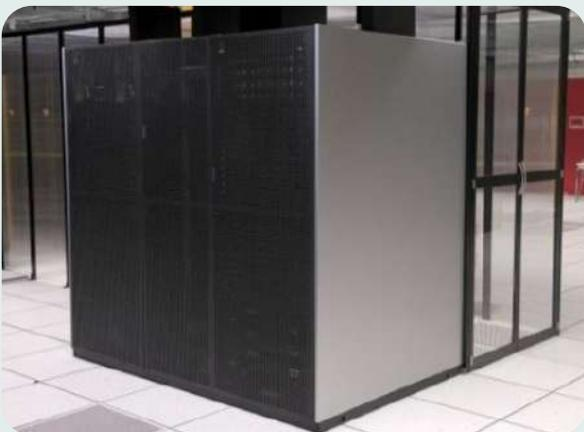
En 2017, cet environnement permet d'offrir 2 Po de données sauvegardées sur l'espace (/store2) du serveur de fichiers avec des débits cumulés de 50 Go/s vers le supercalculateur OCCIGEN. L'espace de stockage (/scratch) local de 5 Po, directement relié au supercalculateur à haut débit (100 Go/s), n'est pas sauvegardé.
