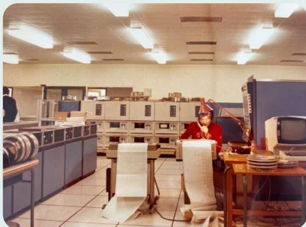
L'utilisation de la ressource CPU optimisée par la technique de multiprogrammation permettait d'exécuter 10 à 15 travaux simultanément. Chaque travail qui s'exécutait bénéficiait d'environ 10 Mo de mémoire virtuelle. Une grande partie de ces travaux était soumise en batch. On est très loin des performances actuelles ! Les heures de calcul sont « facturées » aux utilisateurs.
