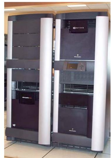
Un équipement de visualisation scientifique local permet de représenter par des séquences animées les résultats des calculs. Il s'appuie sur un serveur **Onyx2** équipé de 4 « pipes » graphiques IR3, 8 processeurs et 4 Go de mémoire. Le logiciel Vizserver (SGI) permet de visualiser à distance (sur le bureau de l'utilisateur) les séquences animées en minimisant la bande passante réseau par compression du flux vidéo.
